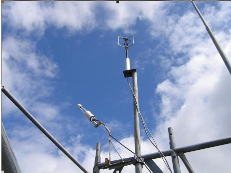
*Figura 13. – Analisador das concentrações de CO<sub>2</sub> e H<sub>2</sub>O “open path” IRGA Li-7500 e anemómetro ultra-sónico Gill R2, respectivamente à esquerda e direita na fotografia*
